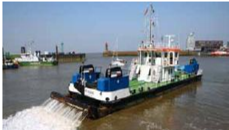
Abb. 19: Wassereinjektion zur Vermeidung von Sedimentation
