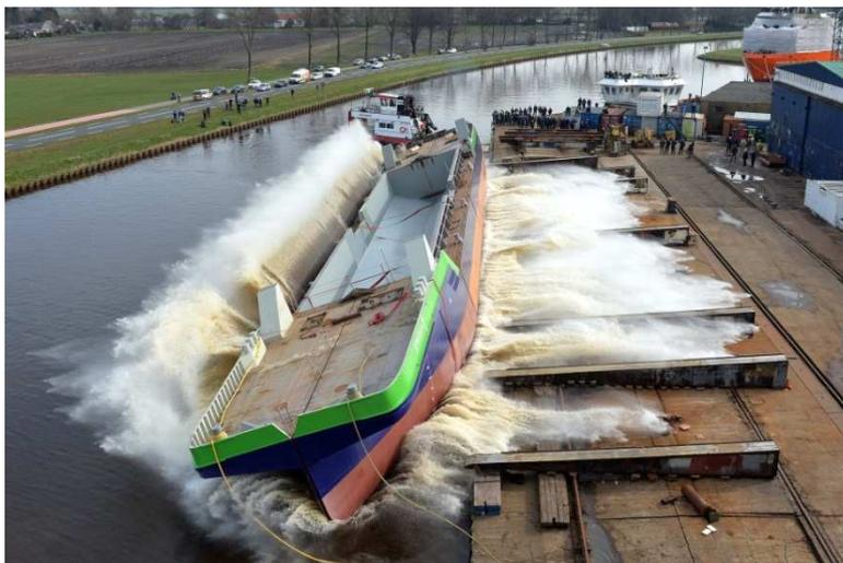
Abb. 14: Stapellauf der für LNG-Antrieb vorgesehenen greenports 1
