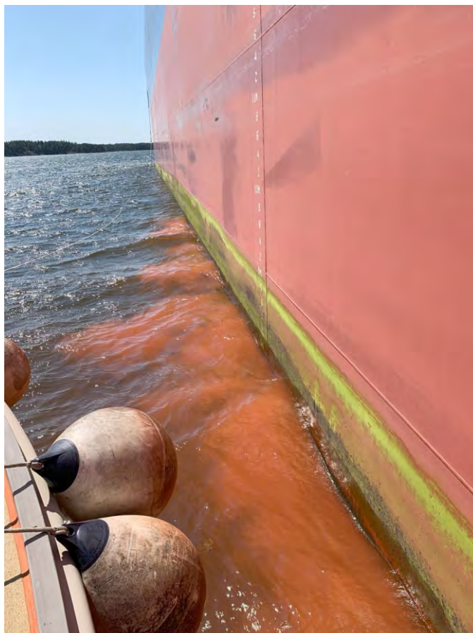
Abbildung 14: Unsachgemäße und illegale Reinigung auf versagender Antifouling - Beschichtung
