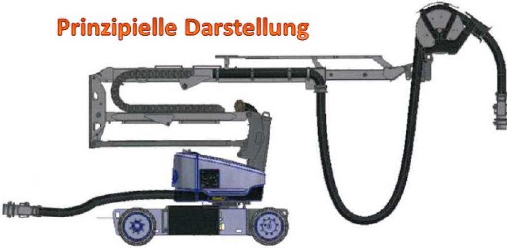
Auf der Kaje wird ein Kabelkranfahrzeug in die Position der Landstromlücke des Autoschiffs gefahren, ebenso die Steckdosenbox an der Kaje. Das Kabelkranfahrzeug wird an die Steckdosenbox angeschlossen und reicht das Landstromkabel mit Stecker zur Landstromlücke hoch.
