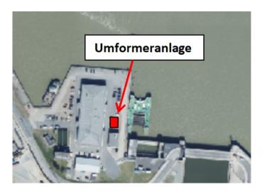
Die Umformeranlage wird fern der Kreuzfahrtkaje am Nordende der Kaiserschleuse aufgebaut. Sie wandelt den Netzstrom vom EVU in den Bordstrom mit der jeweilig notwendigen Spannungshöhe und Frequenz um. Die Umformeranlage wird über eine neu zu bauende 20kV-Einspeisung vom EVU Eurogate-TS versorgt. Diese Leitung muss relativ aufwendig durch das Hafenbecken auf die Columbusinsel verlegt werden.
