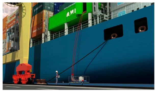
Containerschiffe führen die zwei Anschlusskabel an Bord mit.
