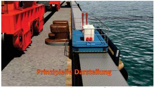
Direkt an der Kaje vor den Pollern wird ein flaches, ca. 400m langes Schienensystem mit innenliegendem Kabelschlepp aufgebaut. Auf diesem Schienensystem verfährt ein Fahrzeug mit 2 Steckdosen.
