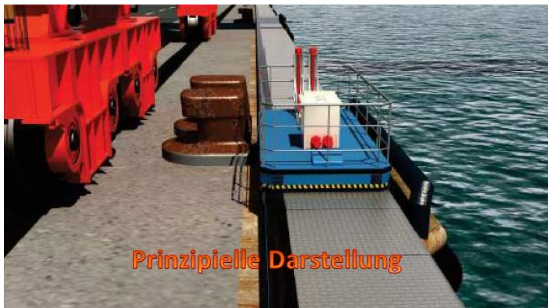
Vor den Pollern direkt an der Kaje wird ein flaches, ca. 400m langes Schienensystem mit innenliegendem Kabelschlepp aufgebaut. Auf diesem Schienensystem verfährt ein Fahrzeug mit 2 Steckdosen.
