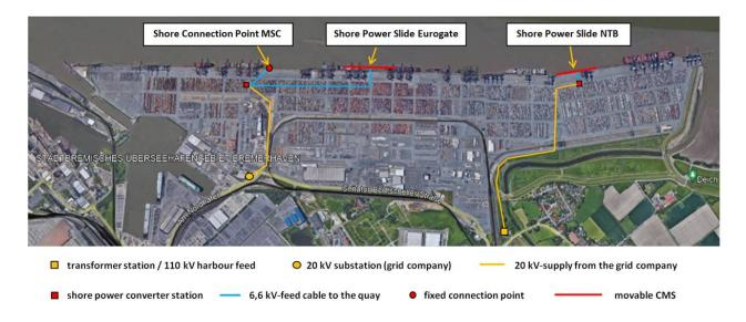
Im Kajenbereich des Terminalbetreibers **MSC** wird ein fester Liegeplatzbereich mit einer Landstromversorgung ausgebaut – in der Abbildung "Shore Connection Point MSC".
