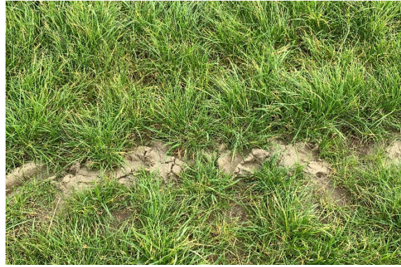
Bentonit-Pellets 2 Wochen nach Einbau
