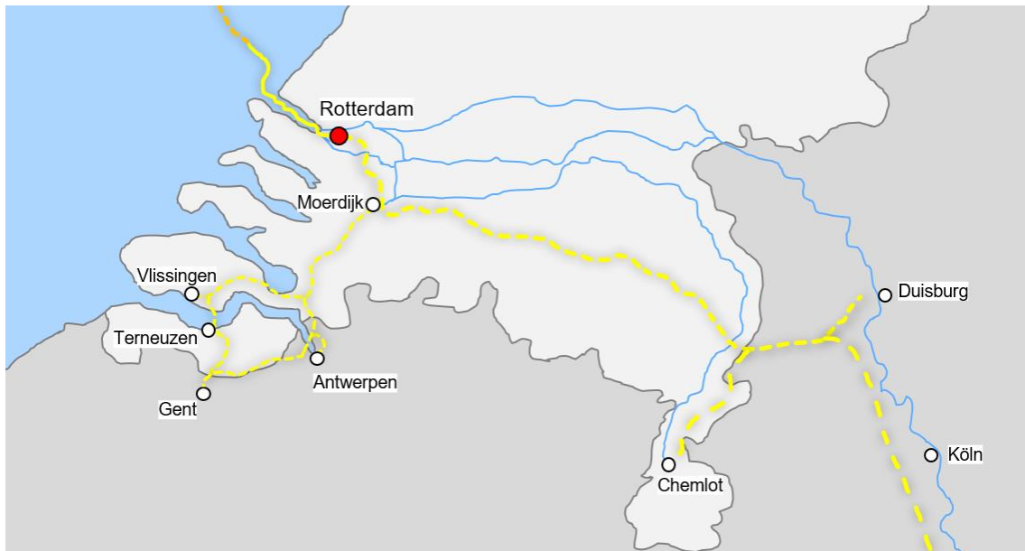
Abbildung 9: H 2 -Pipeline-Anbindung zwischen Gent, Rotterdam und Antwerpen
