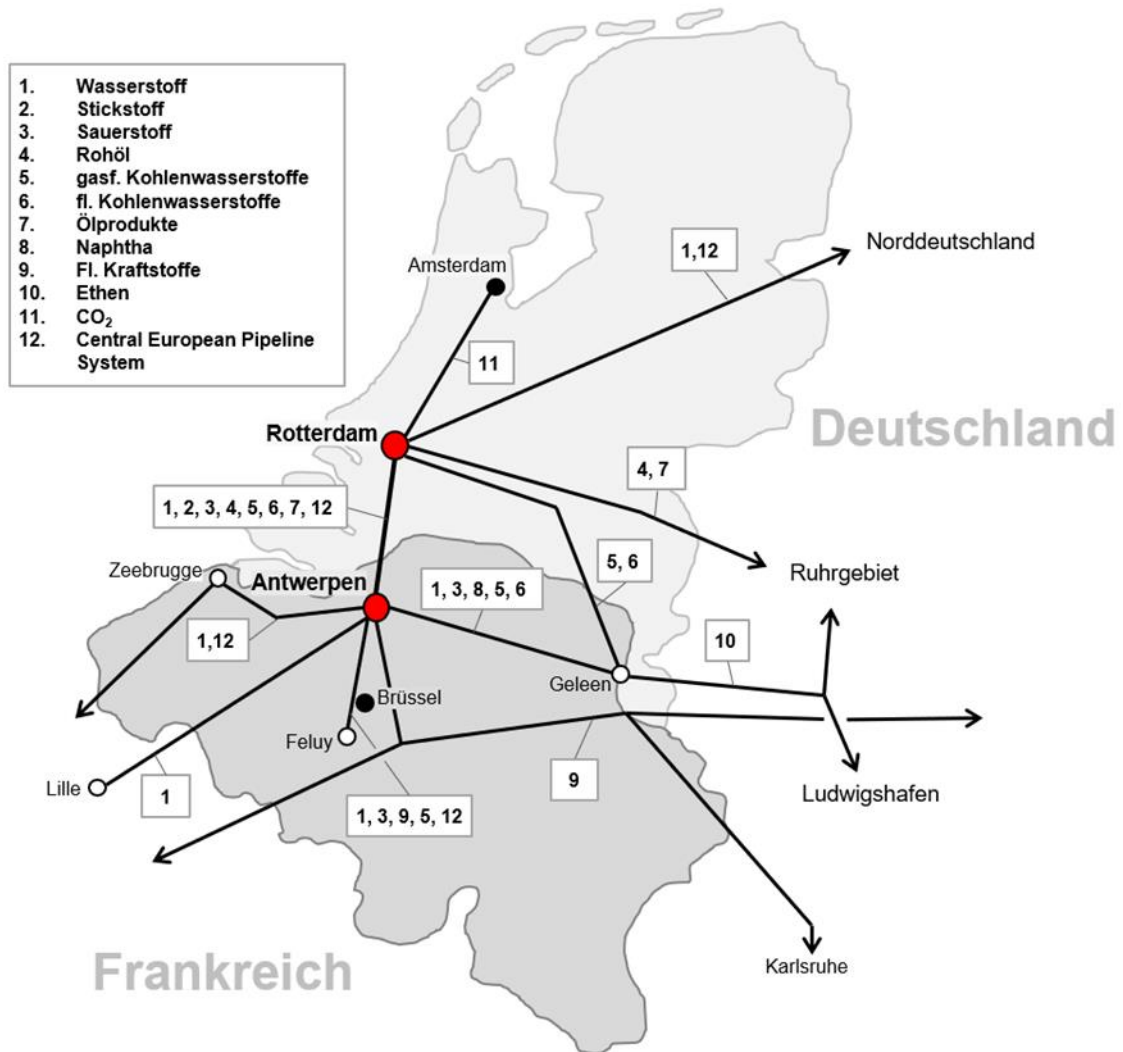
Abbildung 8: Pipeline-Anbindungen zwischen Antwerpen und Rotterdam
