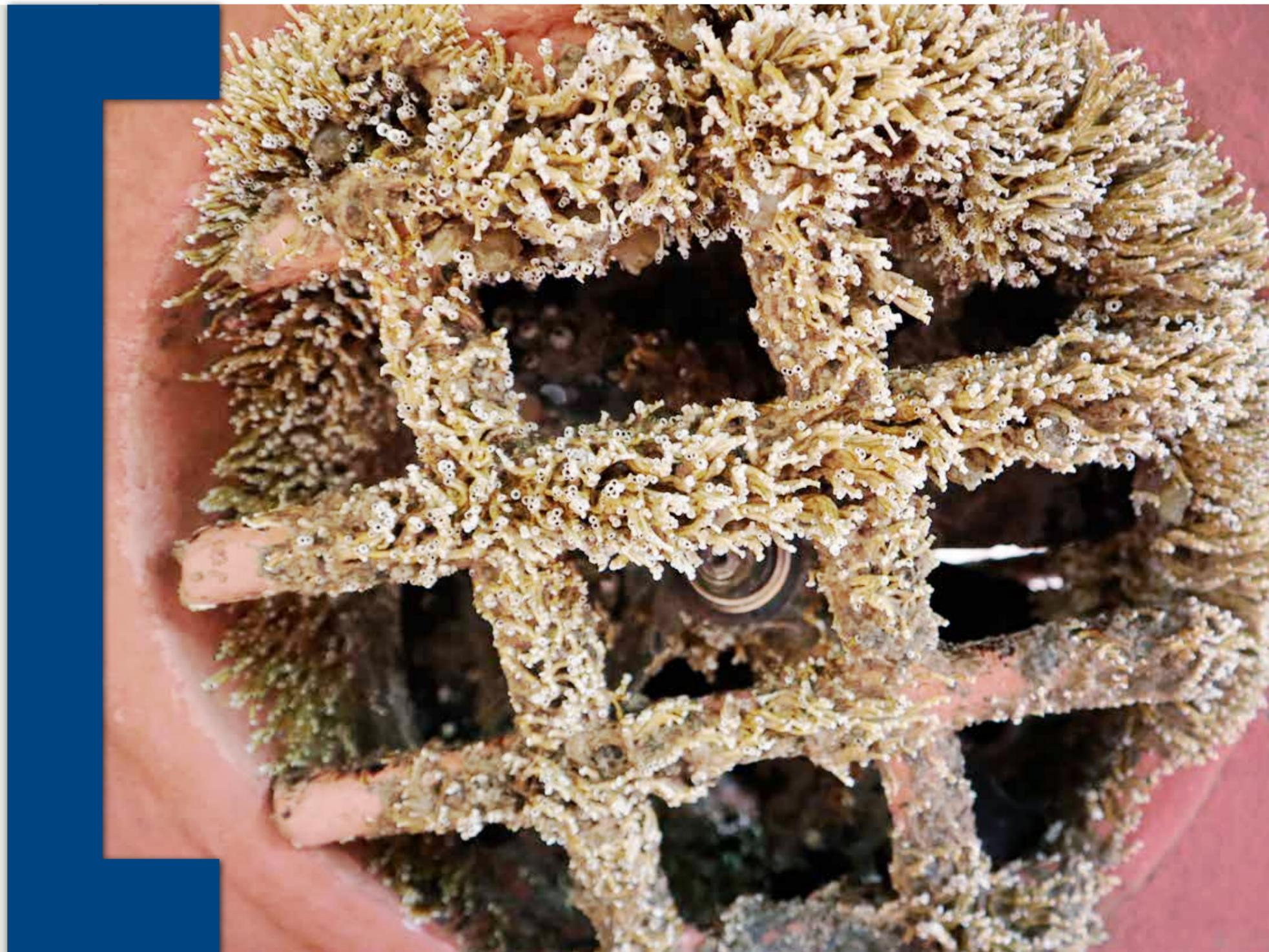
Bewuchs auf einem Bugstrahlruder durch den Tüten-Kalkröhrenwurm
