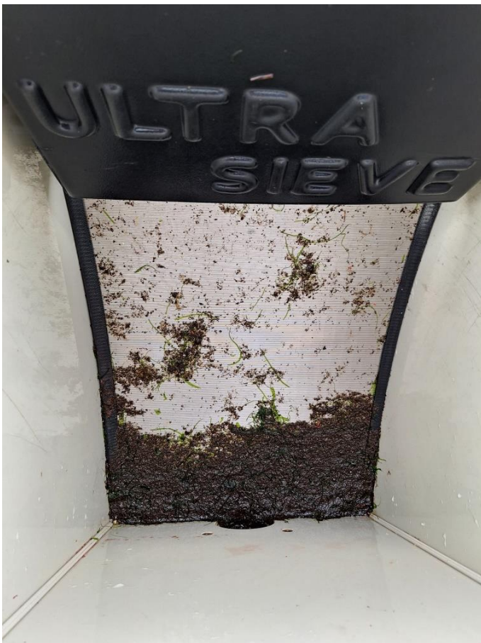
Abb. 8: Im Feinsieb aufgefangener Bewuchs/Biofilm
